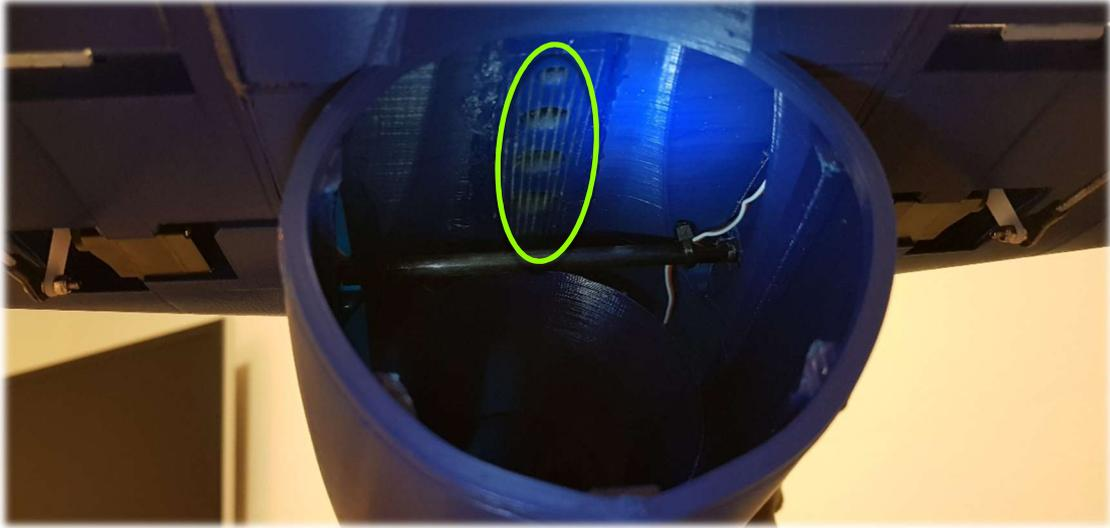
Come si può notare dalla foto i fori della centina della deriva sono stati chiusi perché con questa soluzione il tubo di scarico può essere tagliato prima del carbonio. **N.B.** il tubo di scarico può essere tagliato anche a filo fusoliera, nel kit viene fornito per essere utilizzato in entrambi le soluzioni.
