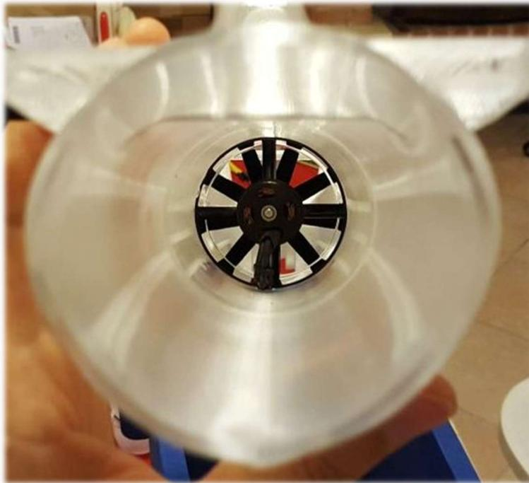
Dettaglio venturi scarico posteriore
