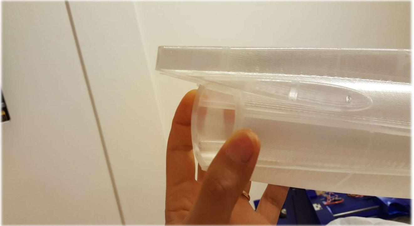
Tubo venturi con incollaggio sezione finale della fusoliera
