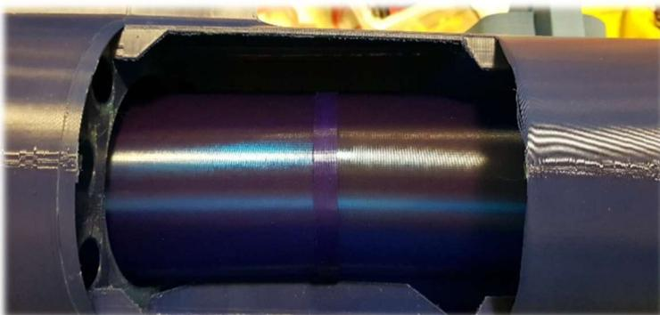
Una volta incollati gli anelli di raccordo inserire le sezioni all'interno della fusoliera e innestarle tra di loro incollandole successivamente esternamente
