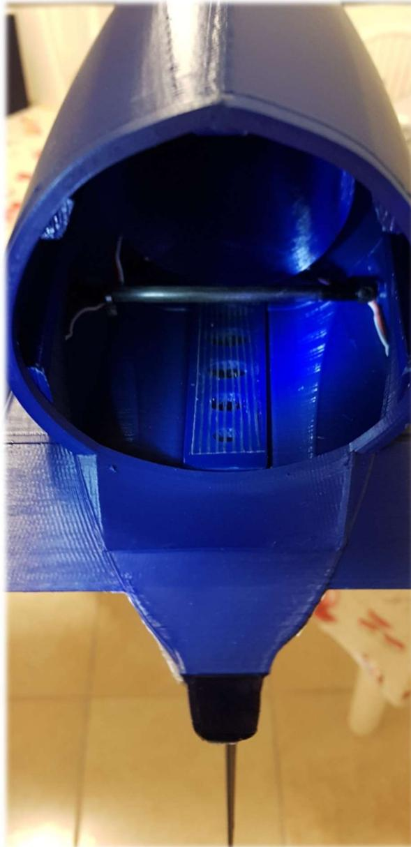
Dettaglio dell'incollaggio della centina della deriva, è importante far coincidere il forto di fissaggio del carbonio diametro 6mm proveniente dalla sezione superiore della deriva.
