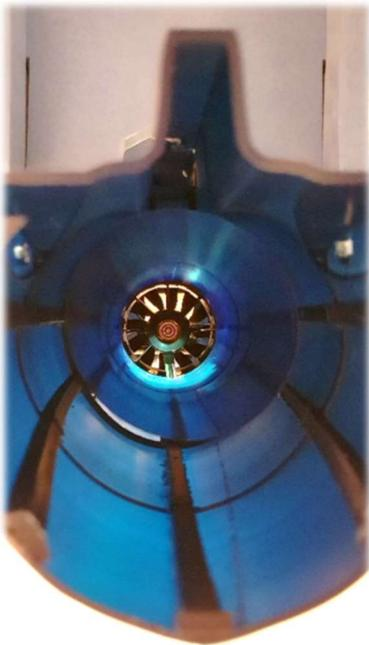
Opzione 1 : Dettaglio con installazione dello scarico solo con sezione 1 e 2. In questo caso si consiglia di chiudere con nastro telato i fori della centina della deriva come mostrato precedentemente, in modo tale che l'aria di scarico ha un flusso pulito in uscita.
